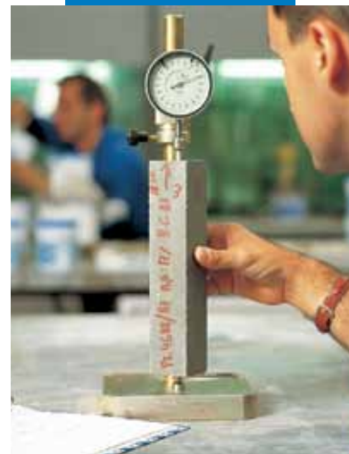
Προσδιορισμός διόγκωσης με περιορισμό σύμφωνα με το πρότυπο UNI 8147
